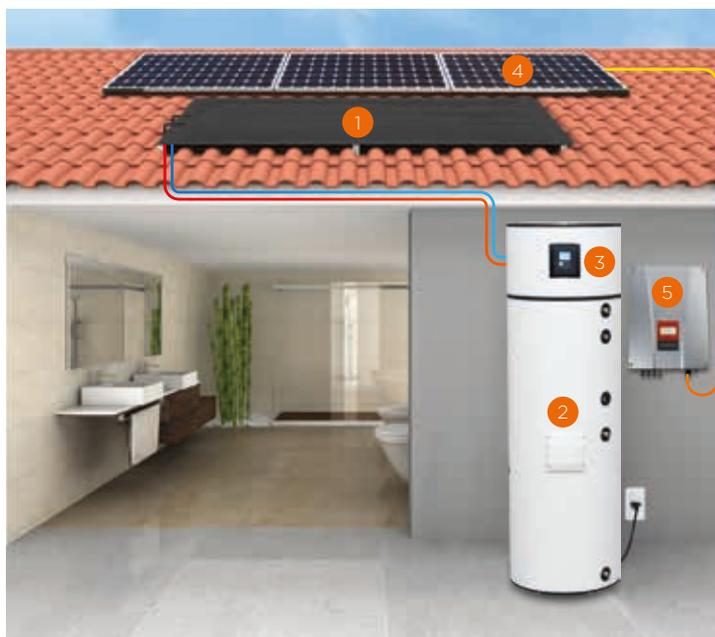
1. Panel Solar Termodinámico. 2. Termoacumulador.
